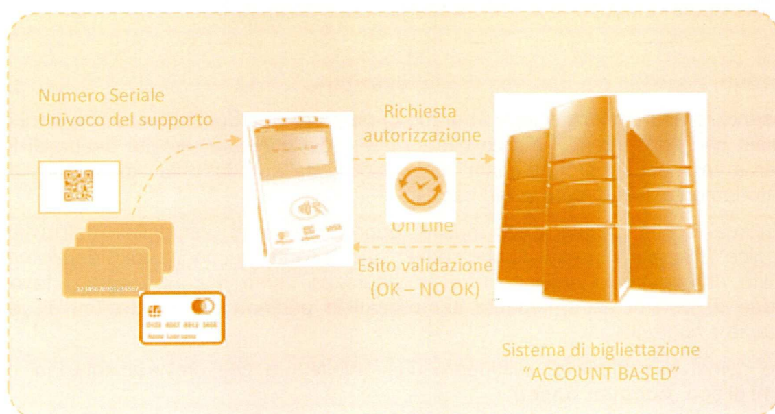
Figura 3 - Schema logico di funzionamento di un Sistema di Bigliettazione Elettronica "Account Based"
