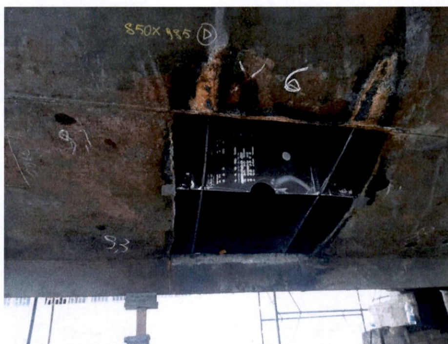
24. in evidenza sostituzione madieri e paramezzale sinistro – ordinate n. 39 e 40
