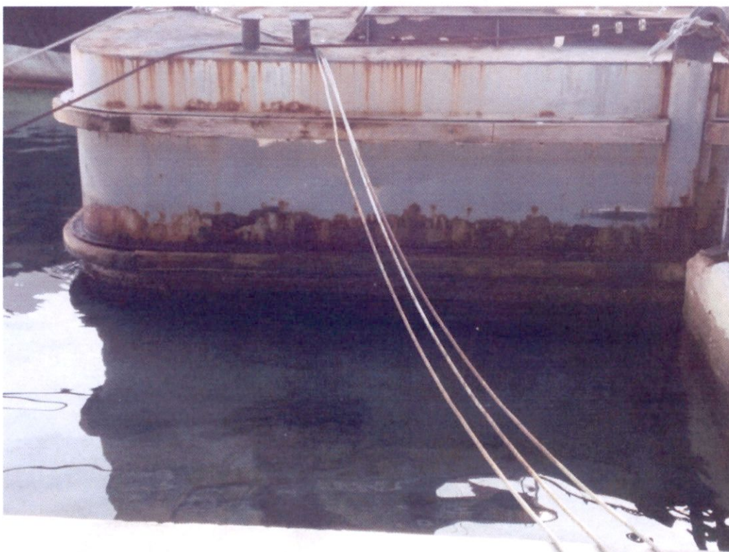
Bagnasciuga pontone con apprezzabile riduzione di pescaggio (circa 10 cm)
