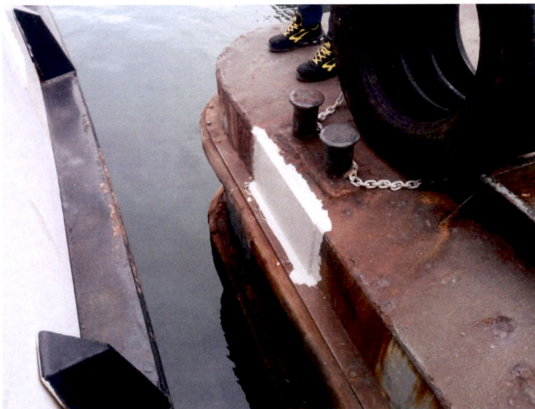
Raddoppio di lamiera per la presenza di buchi
